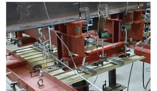
写真1 試験状況(野縁直交方向)
