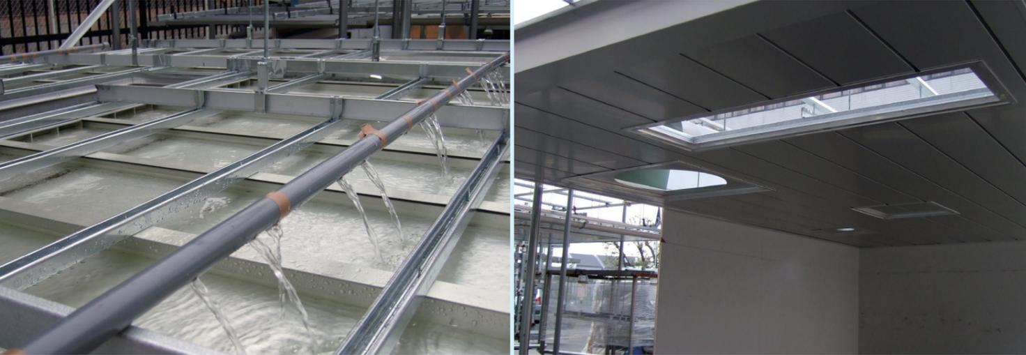
現在、高架下駅や地下駅等の駅舎天井では、漏水問題が深刻化しています。ボード系材料が水分を吸収してもろくなり、落下する事象が発生しているのです。中でも、高架下駅においては、高架橋から流れ出る雨水の問題が懸念されています。漏水を完全に防ぐことは困難で、対策としては二重天井で雨水を防ぐという方法が考えられます。ただ、既存高架橋の寸法上、天井が二重となる仕様により天井高が抑えられ、通行するお客さまの快適性を制限する一因となってしまいます。そこで弊社ではJR東日本と共同で、これら別々の性能を持つ天井を一体化し、問題点を解決した商品「流水システム天井」を開発致しました。見た目も従来の金属天井の良さを取り入れ、意匠性にもすぐれており、漏水の多い高架下駅には最適です。
